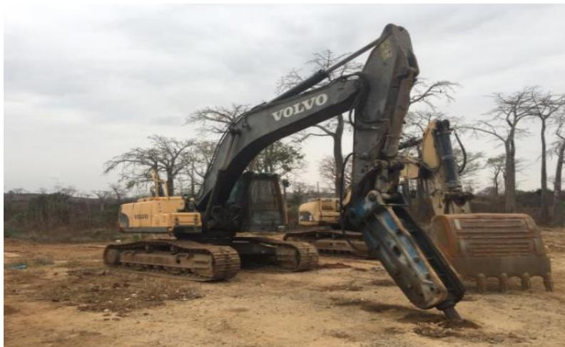
**Figura 6:** Martelo hidráulico na mina em estudo
