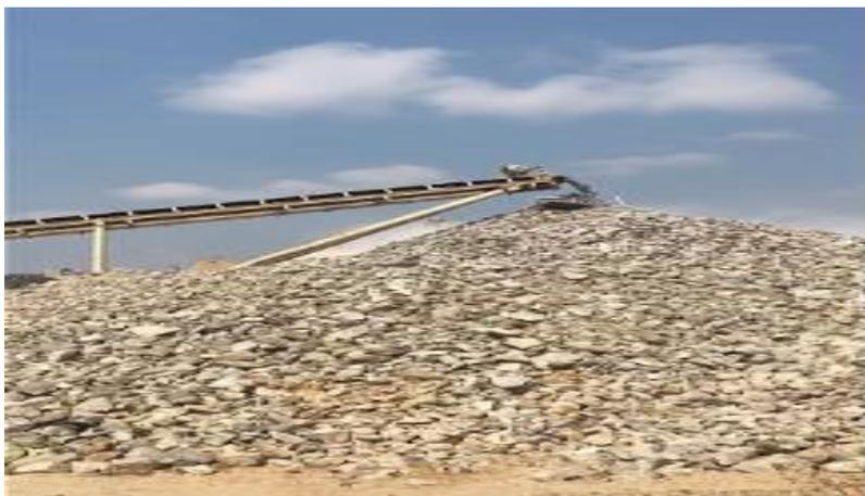
**Figura 8:** Monte de agregado do material detonado
